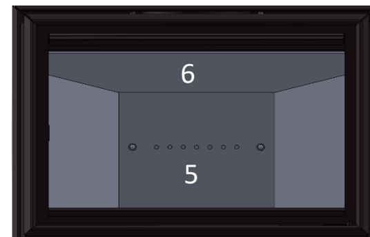
Mettez la brique (5) au fond, boulonnez les 2 écrous borgnes en laissant 1mm de libre avant serrage Glissez le déflecteur (6) en oblique par-dessus. Posez le déflecteur sur la 3, 4, 5 et glissez-le au fond. Pour placer les plaques sur la droite, veillez à les positionner de la même manière que l'image précédente.
